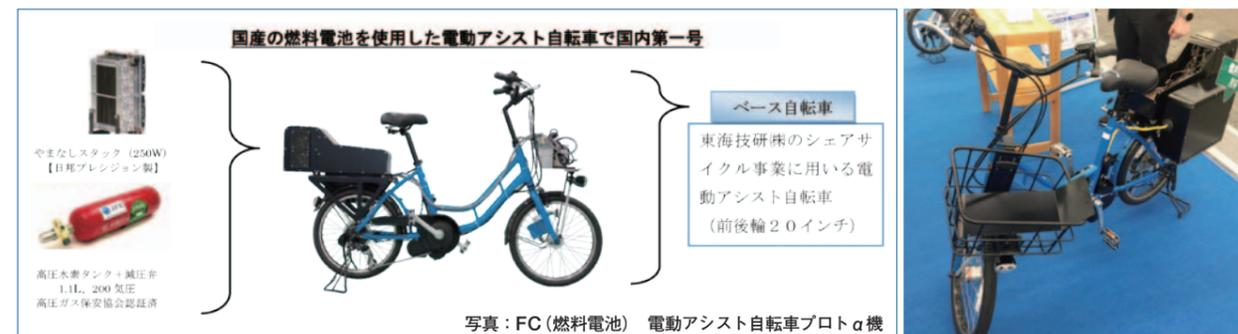
1.1Lタンクを搭載し100km走行を見通す試作機。試験ではタンク残量30%までの使用で69kmを走破しているとのこと。
