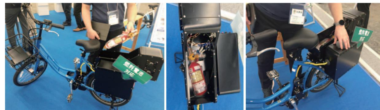
現状はあくまで試作段階のため制御基板等のユニットは大きなものとなっているが、今後は制御基板の小型化、軽量化（約4kg以下）を図っていくという。最終的には現在のリチウムイオンバッテリー式の電動アシスト自転車と同等程度を見通して、将来、市販化される際はユニットが小型化され、デザイン性の両立が可能とのことだ。
